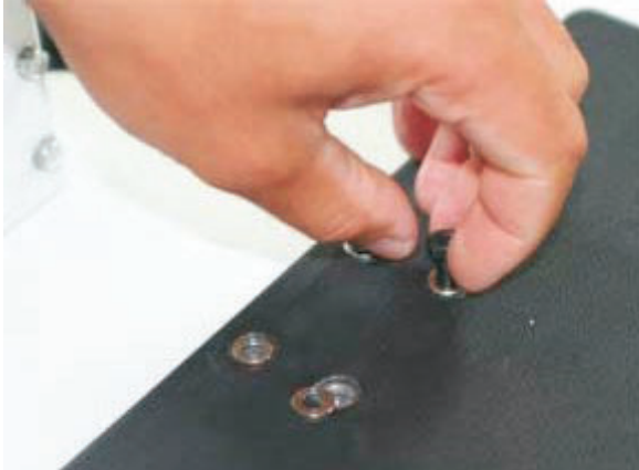
Figura 10. - Retire los cuatro tornillos de cabeza hexagonal de la plataforma de la báscula
