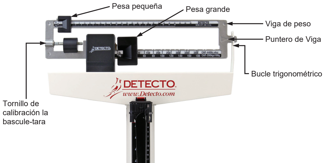
Figura 9. El área de bucle de activación y la ubicación del tronillo de calibración
